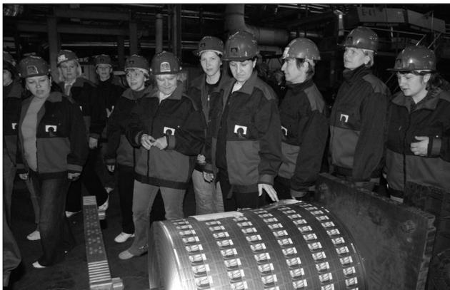
В цехе каширования фольги. Краска на фольгу наносится в несколько слоев. Операция производится на станках с операционным управлением.
