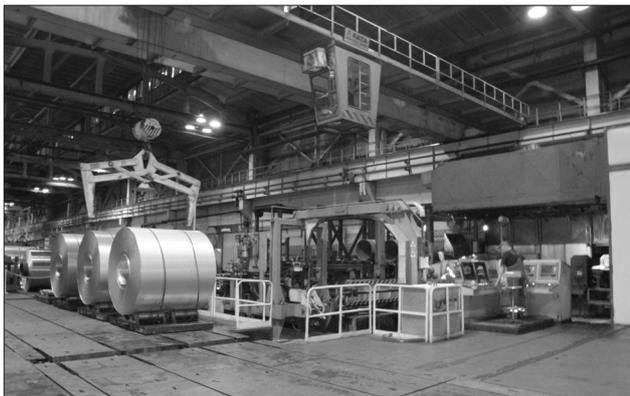
В прокатном цехе тепло и душно, очень шумно. Заготовки для изготовления фольги - вот такие джага-бабины. После прокатки на специальных станках, фольга отправляется на покраску и каширование (проклеивание бумагой).
